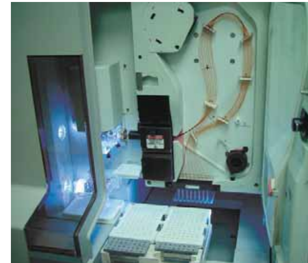
Такой автоматический генный анализатор производства ABI может делать 16/48 (в зависимости от модификации) анализов последовательностей длиной 700—1000 нуклеотидов за 2,5 часа. Анализатор не является прибором нового поколения: он работает на основе обычного капиллярного электрофореза. Подобные приборы — простые «рабочие лошадки» генетиков — входят в состав оборудования «заводов» по массовому секвенированию. ЦКП «Секвенирование ДНК» СО РАН (Новосибирск)
